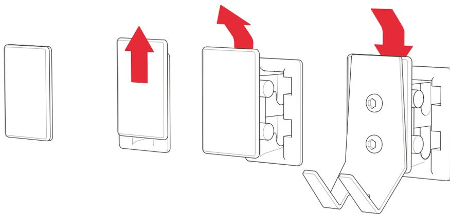
Das MEGAclick System besteht aus zwei Komponenten: Ein Teil ist in der Seitenwand bzw. der Multifunktionswand integriert, der andere Teil direkt am Zubehör befestigt.
